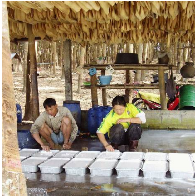
Traitement de la sève de l'hévéa pour en extraire des bandes de caoutchouc brutes mises à sécher.
